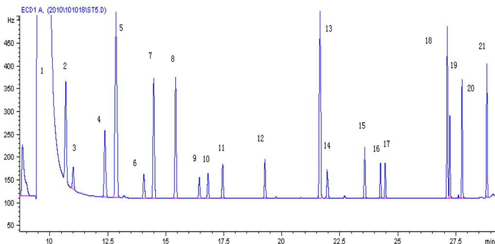
1—二硫化碳（溶剂峰）；2—反式-1,2-二氯乙烯；3—1,1-二氯乙烷；4—顺式-1,2-二氯乙烯；5—三氯甲烷；6—1,2-二氯乙烷；7—1,1,1-三氯乙烷；8—四氯化碳；9—1,2-二氯丙烷；10—三氯乙烯；11—1-溴-2-氯乙烷；12—1,1,2-三氯乙烷；13—四氯乙烯；14—氯苯；15—三溴甲烷；16—1,1,2,2-四氯乙烷；17—1,2,3-三氯丙烷；18—苯基氯；19—1,4-二氯苯；20—1,2-二氯苯+1,3-二氯苯；21—六氯乙烷
