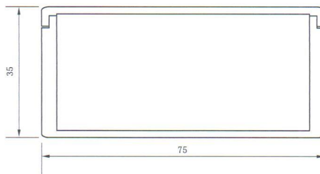
图 B.3 低圆柱形样品盒剖面图
