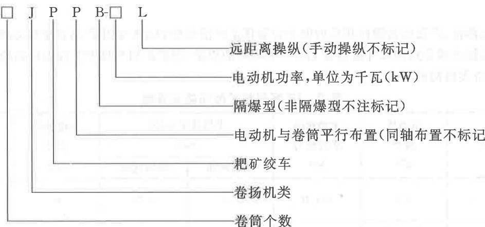
示例 1: 2JPPB-15 表示电动机功率为 15 kW, 手动操纵的隔爆型双卷筒, 电动机与卷筒平行布置的耙矿绞车;
