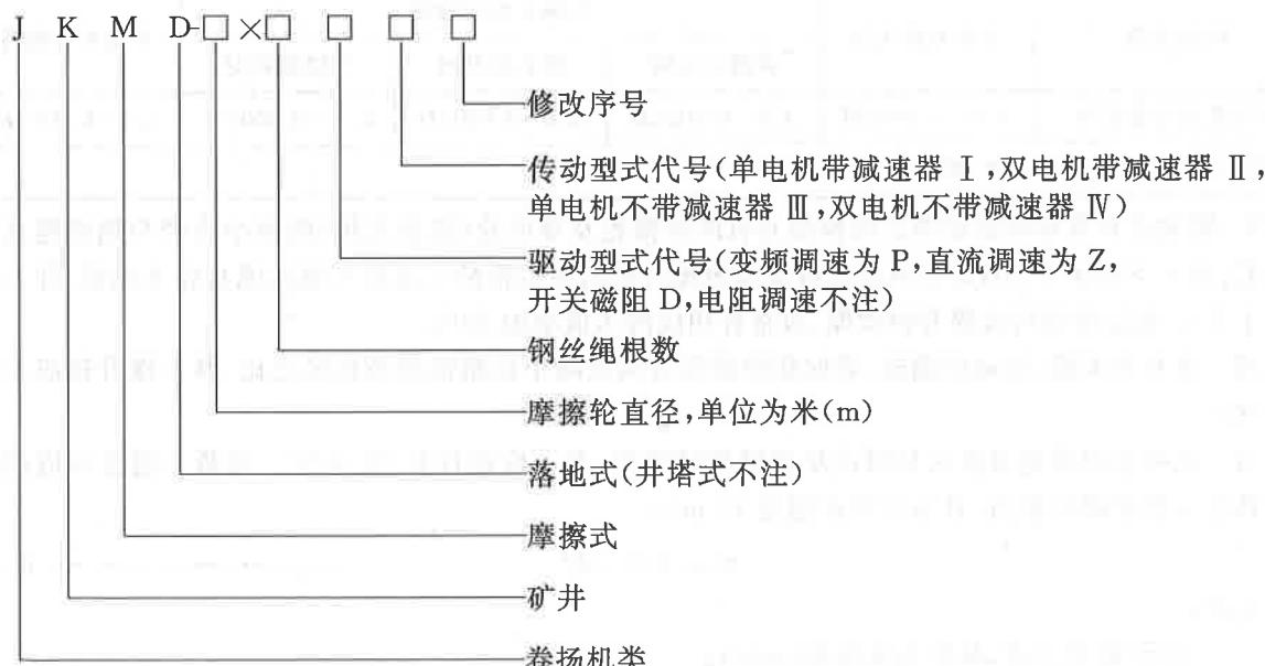
示例 1：摩擦轮直径为 3 m，4 根钢丝绳，单电机带减速器阻阳调速井塔式多绳摩擦式提升机的产品型号为：JKM-3×4I。
